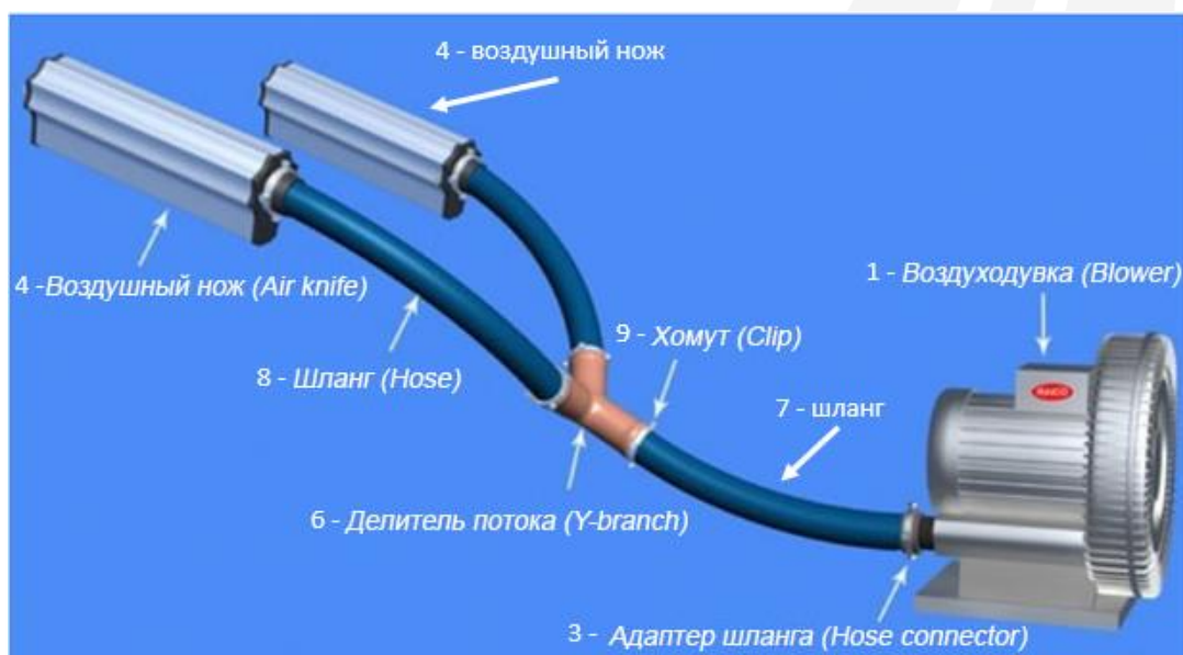
Рис.1. Схема подключения воздушных ножей (2 шт) к воздуходувке.
