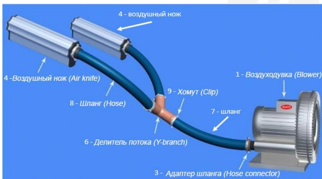
Рис.1. Схема подключения воздушных ножей (2 шт) к воздуходувке.
