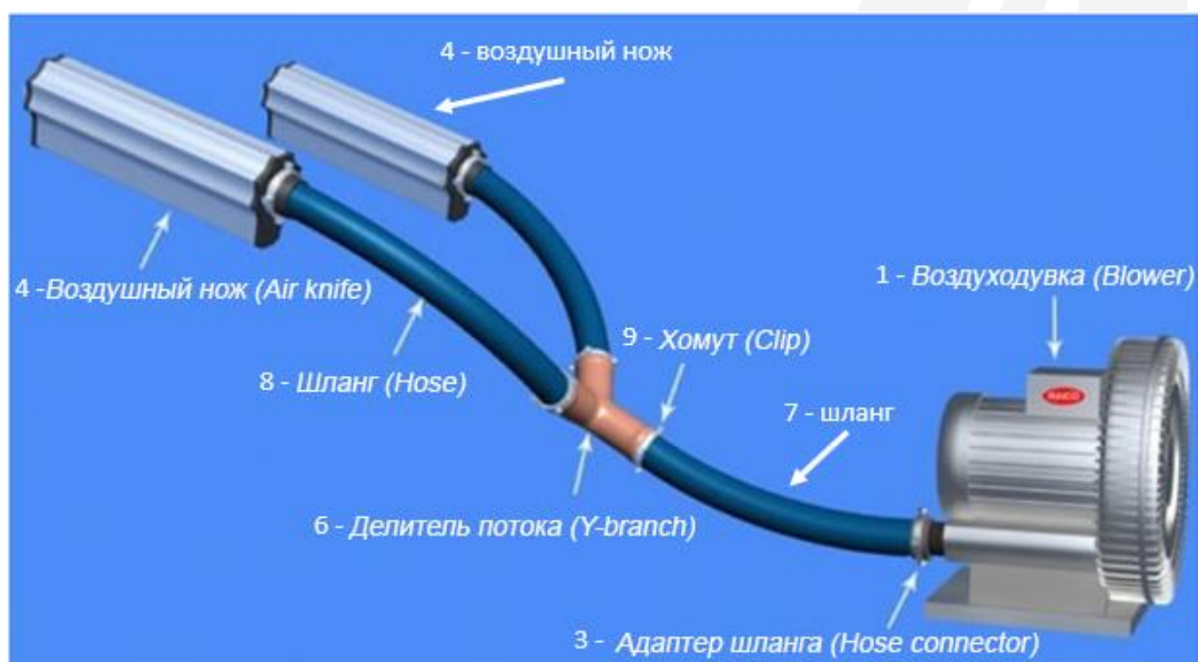
Рис.1. Схема подключения воздушных ножей (2 шт) к воздуходувке.
